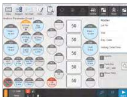
Figura 3 Schermata di gestione dei reagenti. Si può facilmente verificare il volume residuo di reagente, il numero rimanente di test, la stabilità a bordo e altre informazioni.
