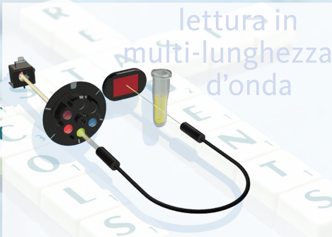
Figura 1 Principio tecnologico della lettura in multi-lunghezza d'onda. Una sorgente alogena invia la luce al sistema di filtri multi-lunghezza d'onda. Ciascuna delle quattro lunghezze d'onda disponibili viene trasportata su fibra ottica al campione da misurare. L'intensità della luce trasmessa attraverso il campione è misurata da un rilevatore ottico. La misura è eseguita selezionando la lunghezza d'onda ottimale per ogni parametro di misura. Nel caso sia rilevata una forma d'onda anormale, l'affidabilità del dato è garantita commutando fra le lunghezze d'onda primaria e secondaria.
