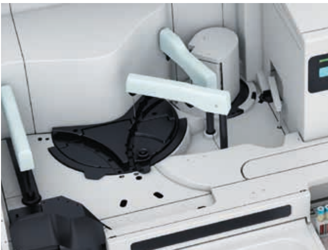
Figura 2 CS-5100 usa tre differenti sonde per dispensare i reagenti, una delle quali è dedicata alla trombina per evitare le contaminazioni ed il rischio di trascinarsi ( carry-over ).
